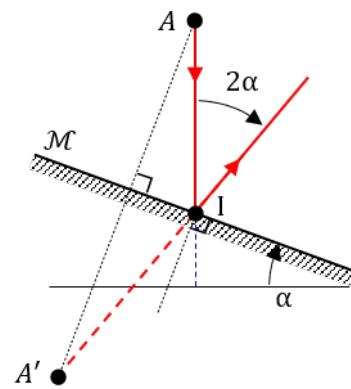
En travaillant dans les triangles rectangles en I, on montre facilement que l'angle d'incidence vaut  $\alpha$ . Donc l'angle de réflexion vaut également  $\alpha$  d'après les lois de Snell-Descartes.
